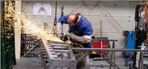
Fertigung von Stahlbauteilen für Schleppschlauchgestänge.
